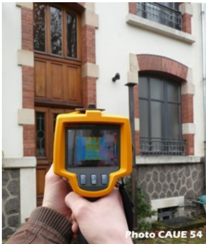
Les caméras thermiques permettent d'évaluer les déperditions des différentes parois d'un bâtiment
