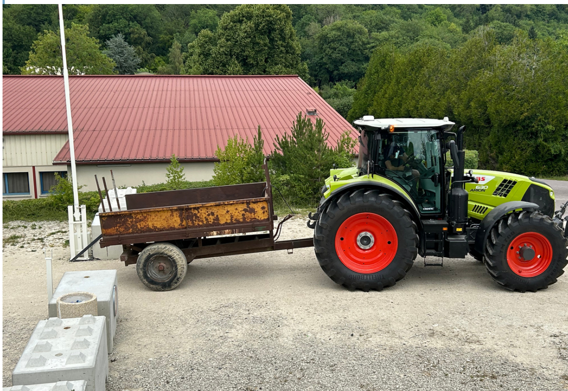
Exercice d'évitement d'obstacles avec un tracteur et une benne : Il consiste à contourner des repères en anticipant le mouvement de recul ou de déport de la remorque
